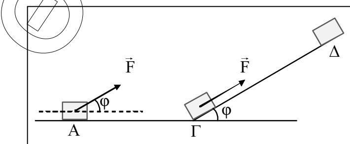
Το σώμα, αφού κινηθεί πάνω στο οριζόντιο επίπεδο για διάστημα  $S_1 = 75$  m φτάνει σε σημείο Γ. Αν ο συντελεστής τριβής ολίσθησης στο οριζόντιο επίπεδο έχει τιμή  $\mu = 0,5$ , να υπολογίσετε:
